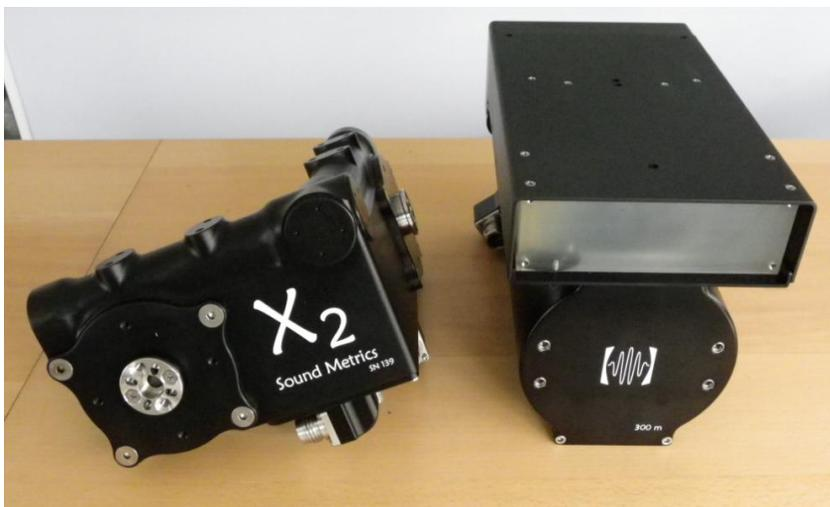
Photo 4.- Sonar Didson 300 et rotateur SMC X2 développés par Soundmetrics.
