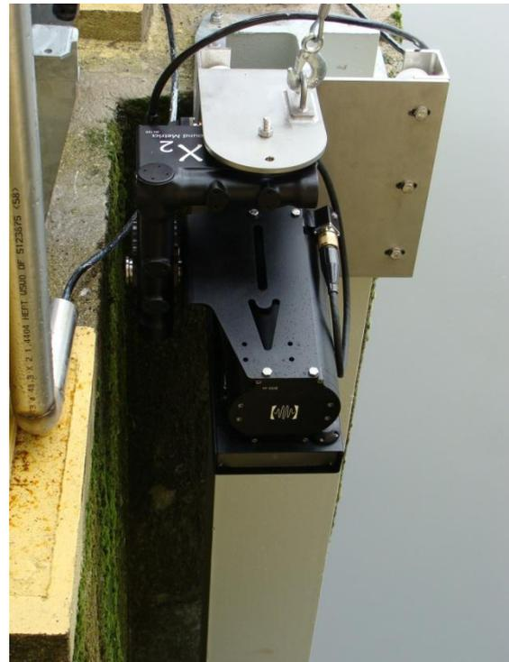
Photos 25 et 26.- Installation de l'ensemble Didson/rotateur et de son chariot porteur sur le HEB.
