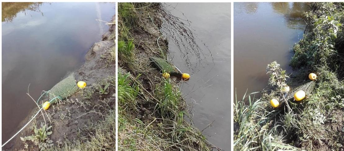
Au total, **le pourcentage d'échouage est de 18% en 2021** (contre 14% en 2020, 26% en 2019 et 25,5% en 2018), soit 26 flottangs échoués sur 143 relèves. Par jour de relève, la proportion d'échouage s'échelonne de 0% à 70%. Par station, le pourcentage d'échouage s'échelonne de 0% à 45%.
