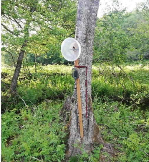
Ce dispositif (figure 2) est placé dans un milieu dégagé sur la berge et orienté vers le lieu de frai afin de capter le maximum d'informations. L'enregistreur quant à lui est placé dans une boîte étanche ce qui permet d'acquérir des données même en cas de précipitations.
