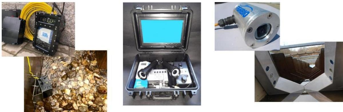
**Illustrations de différents outils pour les suivis vidéos ponctuels ou ciblés (Hydrocam à gauche, caissons caméras Abysses eu centre, prototype FISHBIO à droite)**
